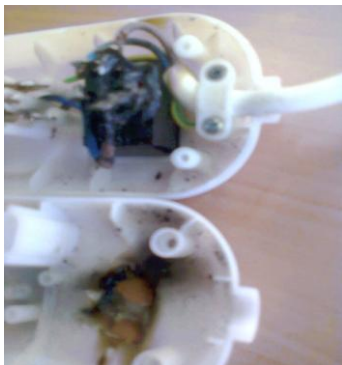
صورة رقم (4) : صور تبين انصهار واحترق موزعات كهربائية
